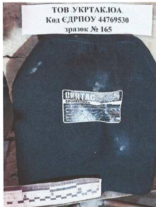
Фото 1.1.1. Зразок до та після випробування (за нормальних умов).
